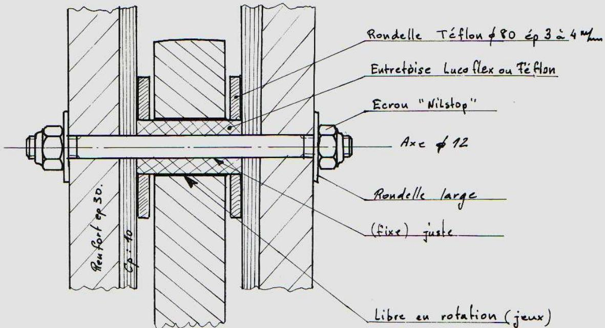
La dérive, articulée librement sur son palier, prend appuis, lorsqu'elle travaille, d'une part latéralement sur les larges rondelles de plastique de l'intérieur du puit, d'autre part, sur les flans intérieurs de l'aileeron; c'est pourquoi nous allons voir sa conformation. Notamment pour ceux qui ont les 1ers plans -
