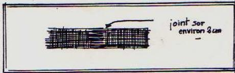
(3) La troisième solution est proposée par P. GUTELLE (Construire son bateau en bois). Il "suffit de défaire" les bords du tissu de verre pour l'effilocheur sur environ 2 cm. Le joint est réalisé assez facilement en les chevauchant sur la même distance. Vous pourrez ainsi les découper aux ciseaux sans problème d'exactitude. Le joint est toutefois moins parfait et il réclamera plus d'enduit et de papier de verre!
